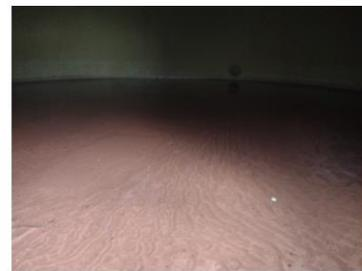
FIGURA 3: AREIA VERMELHA DECANTADA NO FUNDO DO RESERVATÓRIO.
