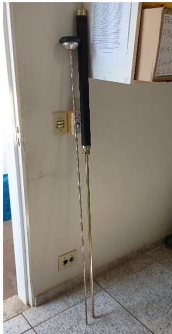
Foto 1: Hastes de perfuração e de escuta - equipamentos utilizados na Fase 2 da pesquisa de vazamentos (Investimento 3).
