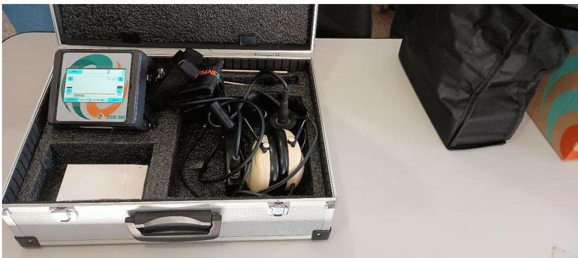
Foto 2: Geofone eletrônico - equipamentos utilizados na Fase 2 da pesquisa de vazamentos (Investimento 3).
