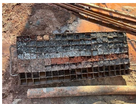
Foto 4 - Amostras da perfuração do novo poço.
